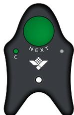
**MP-TX** - Radiocomando alla frequenza standard di 433,92 MHz. E' dotato di un tasto di chiamata (NEXT), di un tasto di codifica (C) e di un LED di conferma. Non disponendo di un display a bordo ne è consigliato l'utilizzo laddove gli operatori abbiano accesso visivo al display riepligativo. In caso contrario si consiglia l'utilizzo della tastiera MP-CONS.
