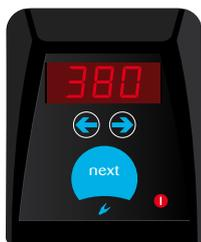
**MP-CONS** - Console di chiamata per operatore. Dispone di un display a LED per l'indicazione del numero di turno. E' dotata di un tasto di avanzamento (NEXT) e di un tasto per apertura/chiusura postazione. Permette inoltre la richiamata del numero, il decremento e l'azzeramento del sistema (solo da sportello 1). E' provvista di un alimentatore esterno a spina per il collegamento alla rete 220 VAC
